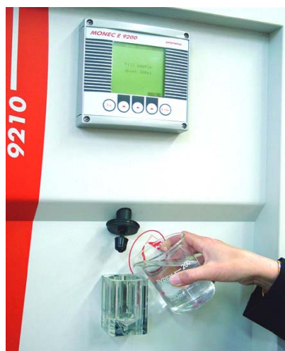
Figur 11: Handprover kan idag utföras på de flesta fabrikat/tillverkares nya analyserare.
